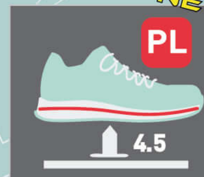
Résistance à la perforation Plaque Composite Pointe Large 4.5mm
